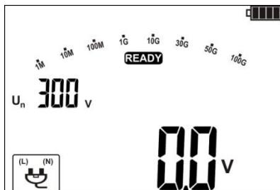
Después de poner el WS-04 / WS-11 al enchufe, en la pantalla aparece mnemotecnía que indica la detección del adaptador.
