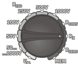
El conmutador rotativo de selección de función debe ser puesto en la posición  $R_x$ .
