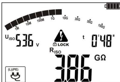
El dispositivo mide la resistencia de aislamiento para los pares de los conductores seleccionados en el orden: LN, L-PE y N-PE.
