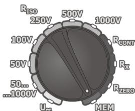
El conmutador rotativo de selección de función debe ser puesto en la posición **MEM**.
