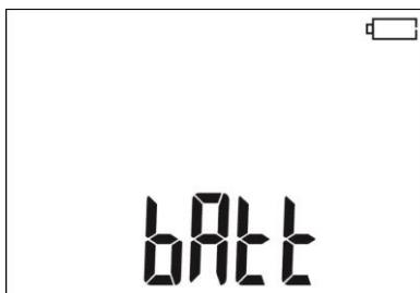
Pilas/baterías casi descargadas.
