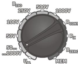
Poner el selector giratorio de función en una de las posiciones  $R_{ISO}$ , seleccionado al mismo tiempo la tensión de medición **MIC-30** en la posición de **50...1000V** seleccionada para este rango cada 10V). El medidor está en el modo de medición de tensión.
