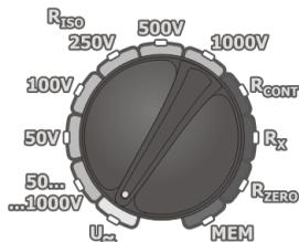
El conmutador rotativo de selección de función debe ser puesto en la posición  $U_{\sim}$ .
