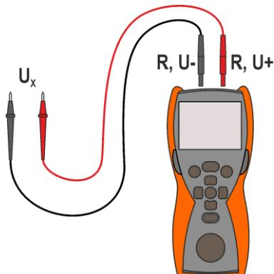
Conectar el medidor a la fuente de tensión.
