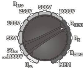
El conmutador rotativo de selección de función debe ser puesto en la posición  $R_{CONT}$ .
